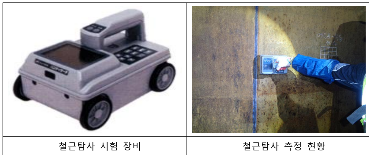
【그림 4.3.2】 철근배근탐사시험 측정 현황
